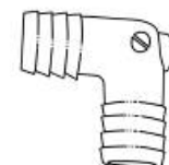
Codos (solo configuraciones CRT y ADJ cuadradas)
