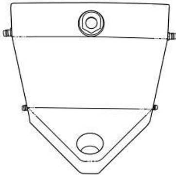
Módulo de llenado (1 por sistema)
